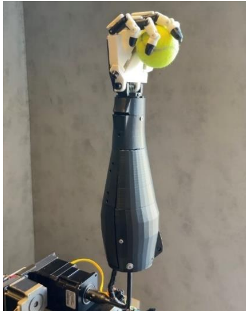
Hình 24. Kết quả cánh tay Robot thực hiện nắm trái banh tennis
