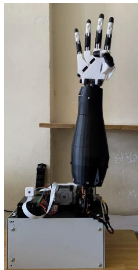
Hình 19. Kết quả cử chỉ tay Robot đếm số 4
