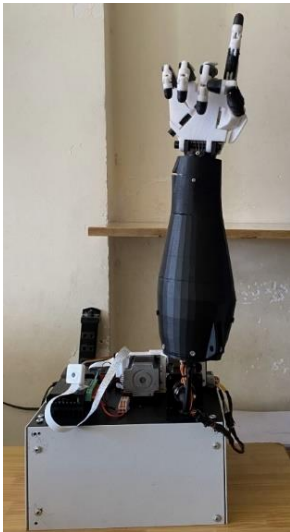
Hình 16. Kết quả cử chỉ tay Robot đếm số 1
