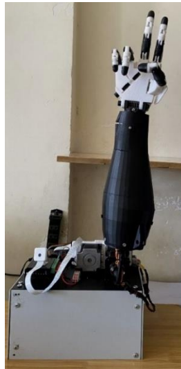
Hình 17. Kết quả cử chỉ tay Robot đếm số 2
