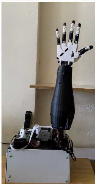
Hình 20. Kết quả cử chỉ tay Robot đếm số 5
