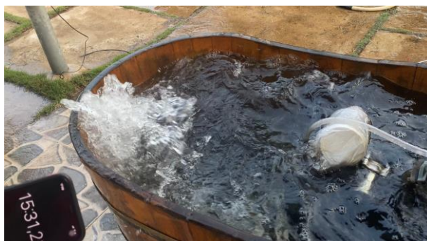
Hình 11. Kết quả thực nghiệm trường hợp nước ngập hết lốc máy
