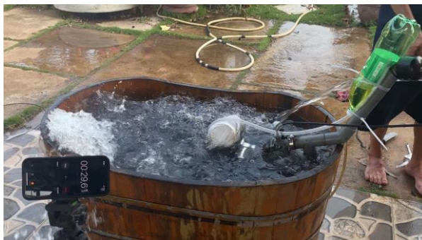
Hình 10. Kết quả thực nghiệm trường hợp nước ngập hết ống pô
