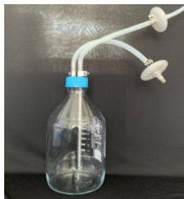
Hình 1. Hệ thống bioreactor tự tạo thể tích 2 lít.
