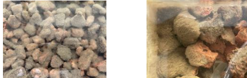
Hình 17. Đá nham thạch trong mô hình sau khi chạy thích nghi với lớp màng vi sinh bám dính
